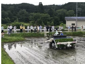
【農業者ほ場で実演が行われた可変施肥田植機(左)、アイガモロボット(中)、リモコン式草刈機(右)】
