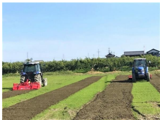
無人ロボットトラクタ(左)と有人機(右)の2台協調作業の実証
