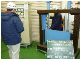
Jロート試験と供試体の採取による品質確保
