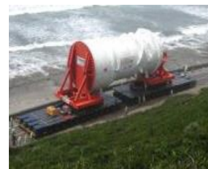
原子炉圧力容器の陸上輸送の様子
