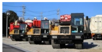
ⓐ可搬型取水ポンプ車
