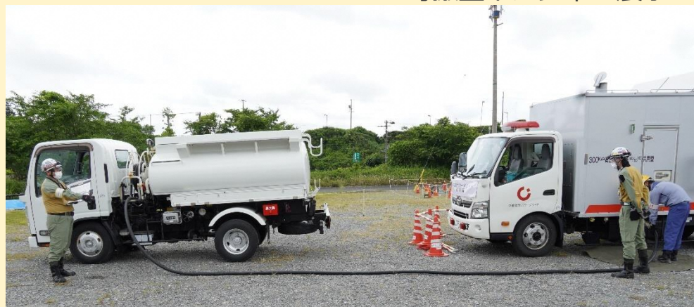
タンクローリーを用いた燃料補給
