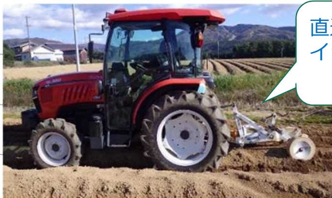
直進アシストトラクタによるサブソイラ作業
