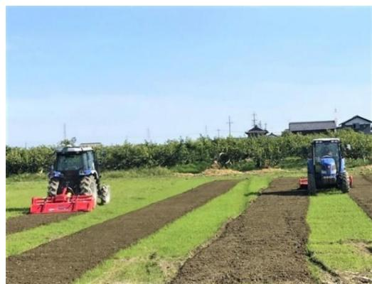
無人ロボットトラクタ(左)と有人機(右)の2台協調作業の実証
