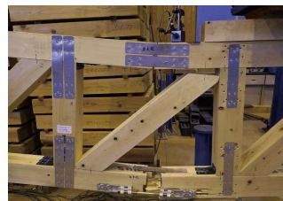
実大曲げ試験（接合部アップ）
