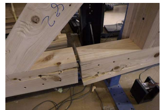
実大曲げ試験（化粧タイプ）接合部アップ
