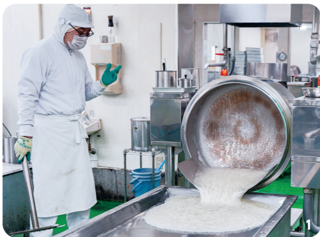
1 電気鍋で炊いた飴を流し込む様子。2 快適な温度の環境、電熱線のもとで飴づくりを実施。3 CO 2 排出量ゼロの工場で作られた飴。
