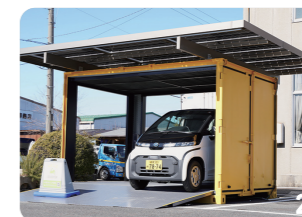
1 太陽光パネル付カーポート。災害時には電力供給が可能。2 コンテナ型のカーポート。容易に設置ができ、移動も可能。
