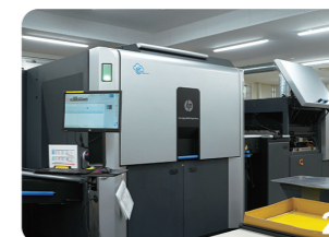
1 グリーンナノクリアファイルのほか、ペーパーファイルも企画・制作。2 大量に安定して印刷でき、ロスが極めて少ない、デジタルオフセット印刷機。
