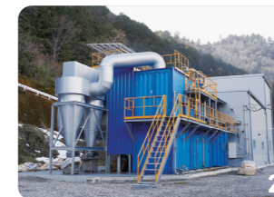
1 LED照明化された、清涼飲料チアーバック製造ライン。2 古紙や廃プラスチック類を主原料とした固形燃料をエネルギーに変えるRPFボイラーを導入。
