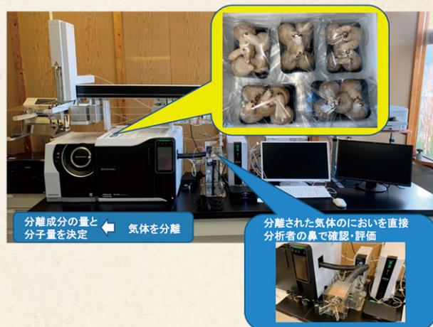
図2 ガスクロマトグラフ質量分析装置（におい嗅ぎ装置付き）を用いた分析
