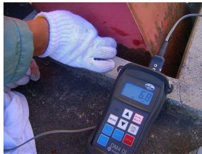
孔食があると、超音波計測器による測定ができないため、ディスクサンダーで鋼材の表面を平坦にしてから作業を行う。ただし、この作業はかなり大変な作業であるため、効率を向上させるために、ノギス等の定規を使用した間接的な計測も併用した。
