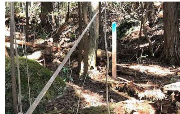
測量用ターゲット設置状況
