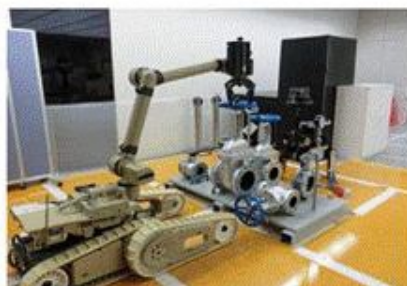
バルブの開閉操作
