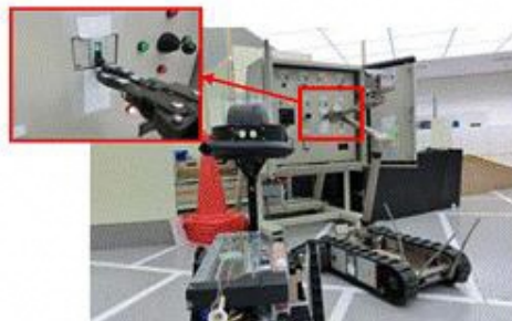
訓練施設におけるロボット操作訓練 （制御盤を開放しスイッチ操作）
