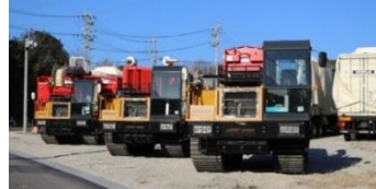
ⓐ可搬型取水ポンプ車
