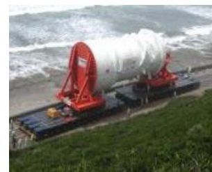
原子炉圧力容器の陸上輸送の様子
