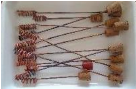
3 酸化銅を水素やイタールで還元する渦巻き銅 【理科】多治見市立小泉中学校 辻 弥生教諭 富田 彰校務員
