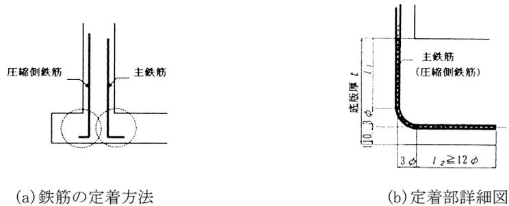
図4.2.32 たて壁鉄筋の定着方法
