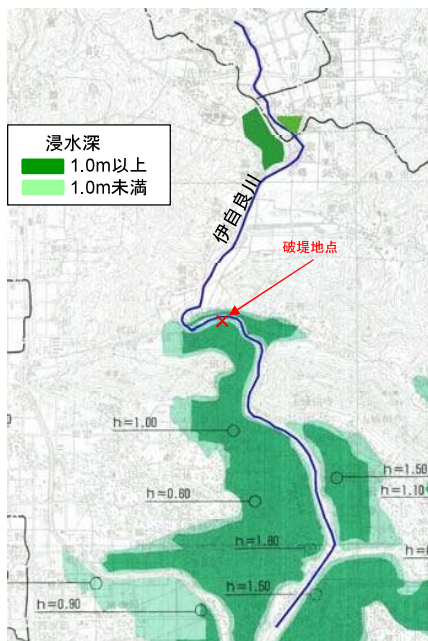
昭和51年9月豪雨被災状況
