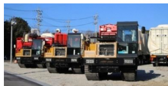
ⓐ可搬型取水ポンプ車
