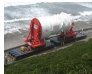
原子炉圧力容器の陸上輸送の様子
