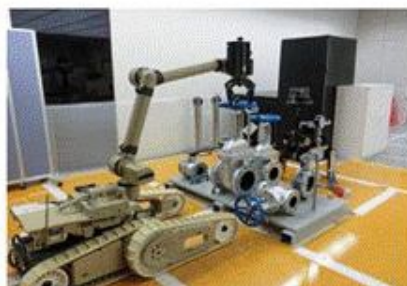
バルブの開閉操作
