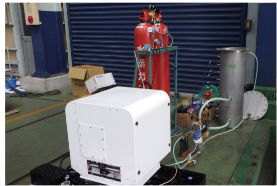
純水素型燃料電池（700W）を用いた熱回収ユニットの試作機
