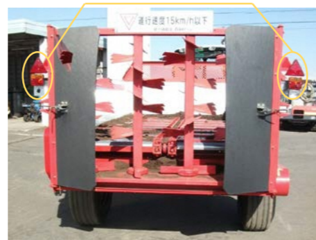
後部反射器及び灯火器類の設置例
