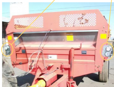
後部反射器及び灯火器類の設置例
