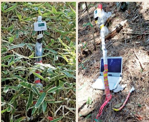
写真 土壌水分率の計測の様子
