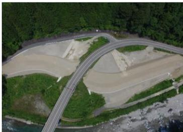
UAVを用いた3次元測量結果に設計モデルを反映した画像
