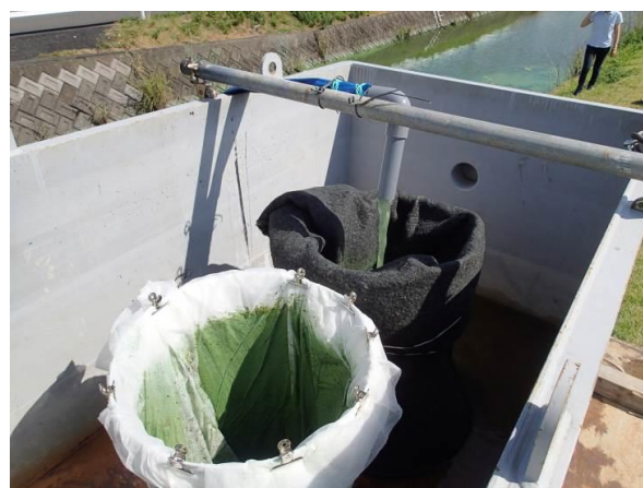
写真 2.4 水中ポンプによる汲み上げとアオコロ過の状況
