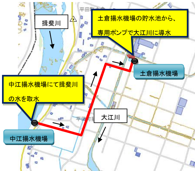
図 2.1 揖斐川から大江川への導水系統
