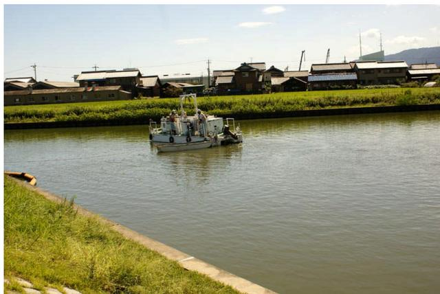
写真－17 水質対策船による攪拌（H24 実施）
