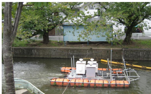
写真2 茨城県土浦市の新川に設置されたアオコ発生抑制装置
