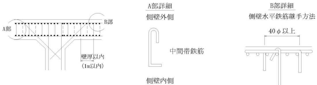
図 3.6.2 側壁水平断面の配筋
