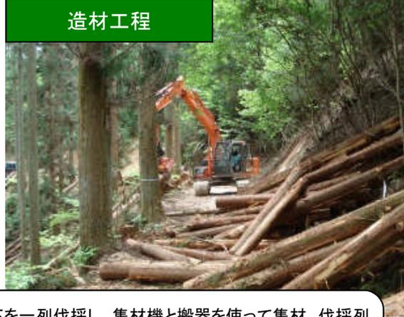
架線下を一列伐採し、集材機と搬器を使って集材。伐採列から斜めに横取集材を実施(列状+定性間伐)。今後、目標とする伐倒・集材方法は、帯状伐採(帯幅は樹高～樹高の2倍)による小規模皆伐+低コスト造林。
