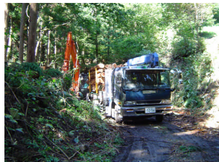
【造材・運材(プロセッサー、グラップル、10tトラック)】
