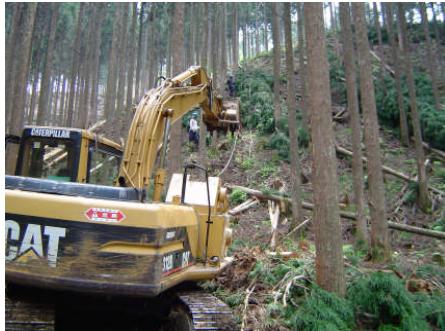
【集材工程(スイングヤーダー)】
