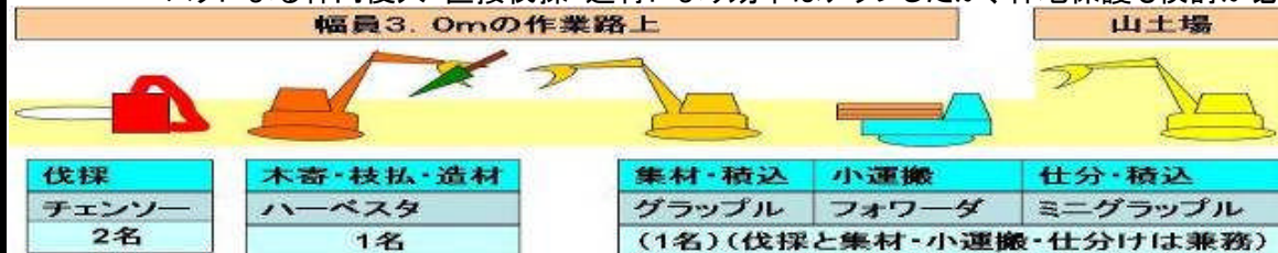
フォワーダ(3t)で小運搬 通常はグラップルで積み込み 時にはハーベスタにより積み
