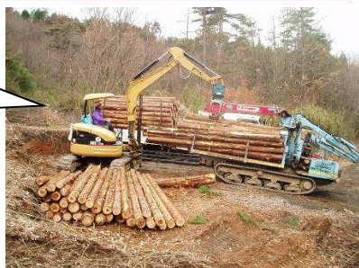
フォワーダ(3t)で小運搬 通常はグラップルで積み込み 時にはハーベスタにより積み
