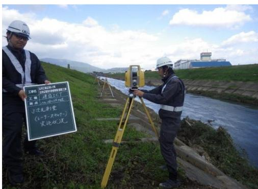
LSによる写真測量(起工測量)
