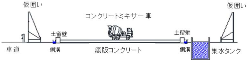
図 2-4(2) 瑞浪市内土岐町発生土仮置き場における主な施工手順（底板コンクリート等設置）
