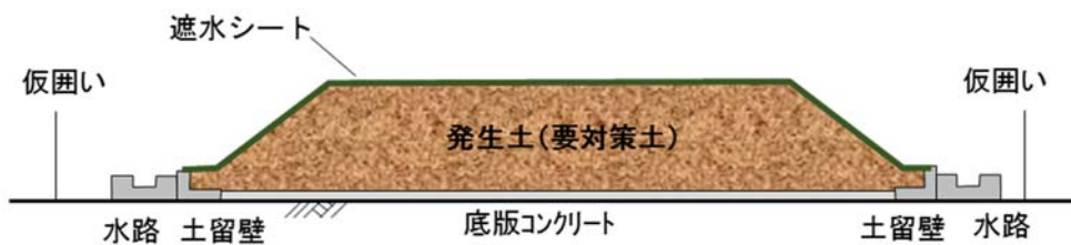
図 2-5(4) 山口下島地区発生土仮置き場における主な施工手順（仮置き）
