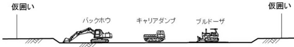
図 2-5(1) 山口下島地区発生土仮置き場における主な施工手順（耕土すき取り）
