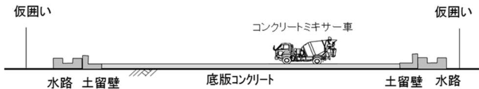
図 2-5(2) 山口下島地区発生土仮置き場における主な施工手順（底版コンクリート等設置）
