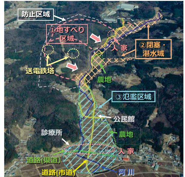
南垣外地すべりの被害想定区域
