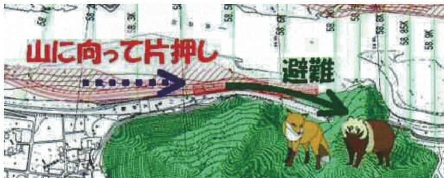
片押し施工 (岩田西地区)
