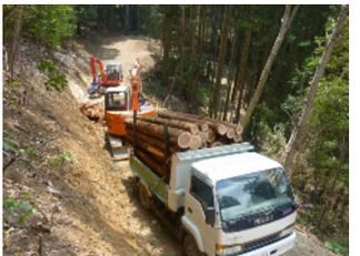
開設作業道を利用した間伐材搬出（川辺町）
