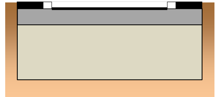
【変更】路床：セメント安定処理
