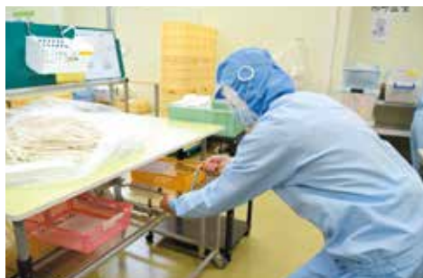
面談で上がった要望から、高さを調節可能な作業台や目にやさしいLEDライトなどを導入し、作業の負担を軽減。
