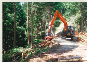
谷口さん操縦のプロセッサによる造材作業
