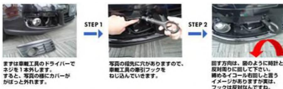
図 4-19 フロントへの取付け例〔4輪の事例〕(Volkswagen Golf)
