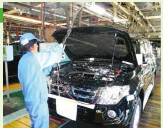
エアコンガス注入真空作業を行う後藤さん
