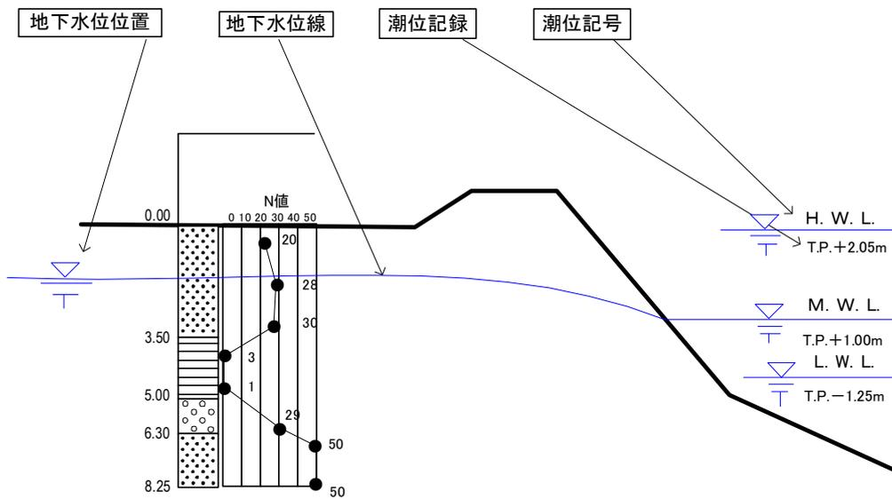
図 3-10 地下水面の記載例
