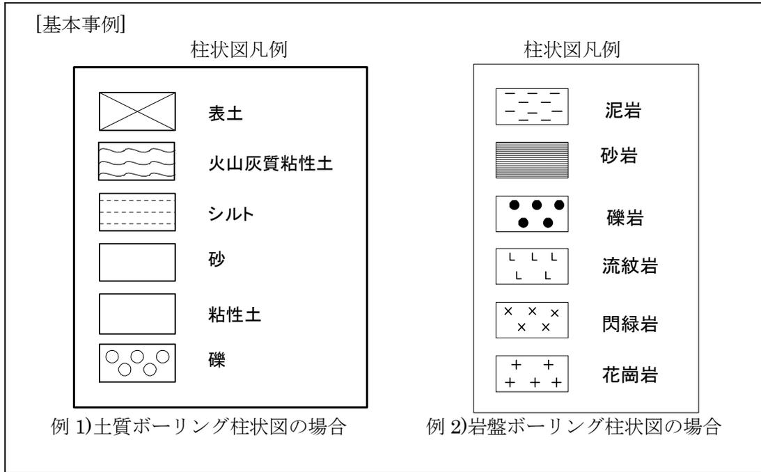
図 3-23 簡易柱状図の凡例の記載例
