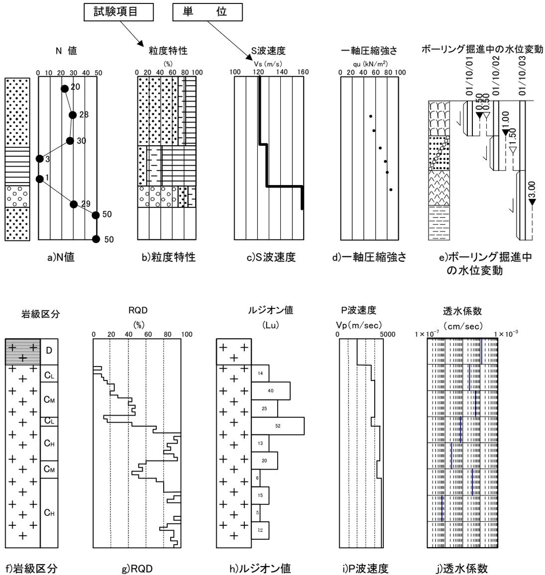
図 3-7 試験・検層データの記載例
