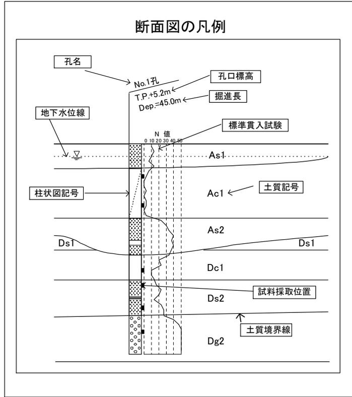
例 1)土質断面図の凡例の記載例
