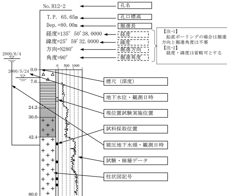
図 3-5 簡略柱状図の記載例
