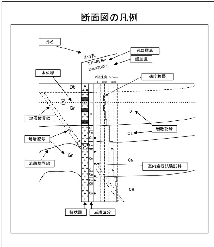
例 2)地質断面図の凡例の記載例
