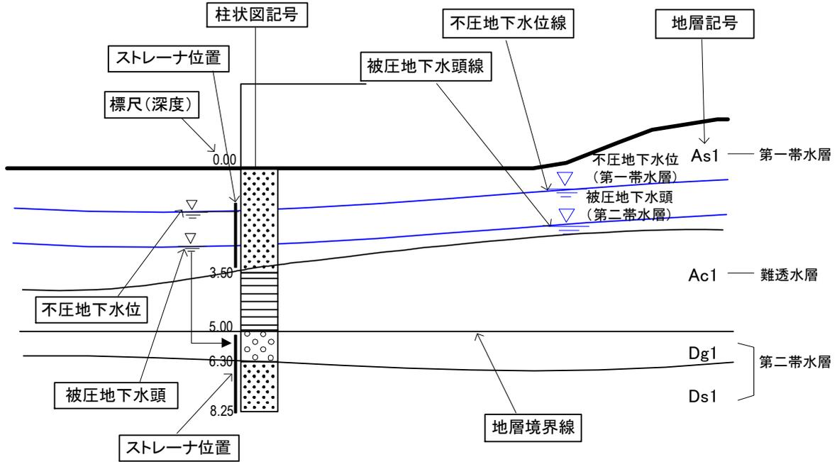
図 3-11 被圧地下水頭の記載例
