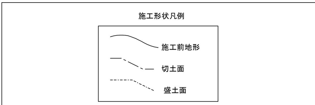
図 3-27 施工形状の凡例の記載例
