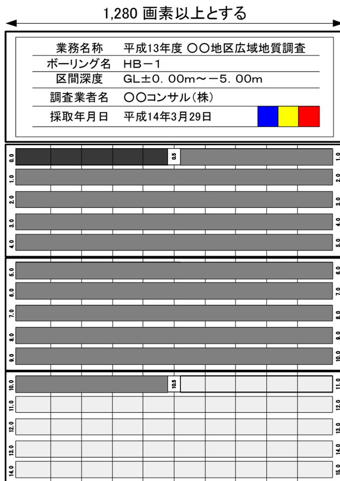
図 6-1 ボーリングコア写真の整理例
