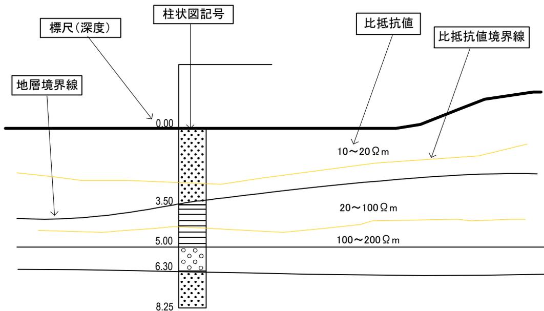
図 3-12 比抵抗断面図の記載例
