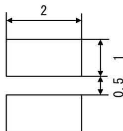
図 3-8 矩形寸法の例(縦横比 1:2)
