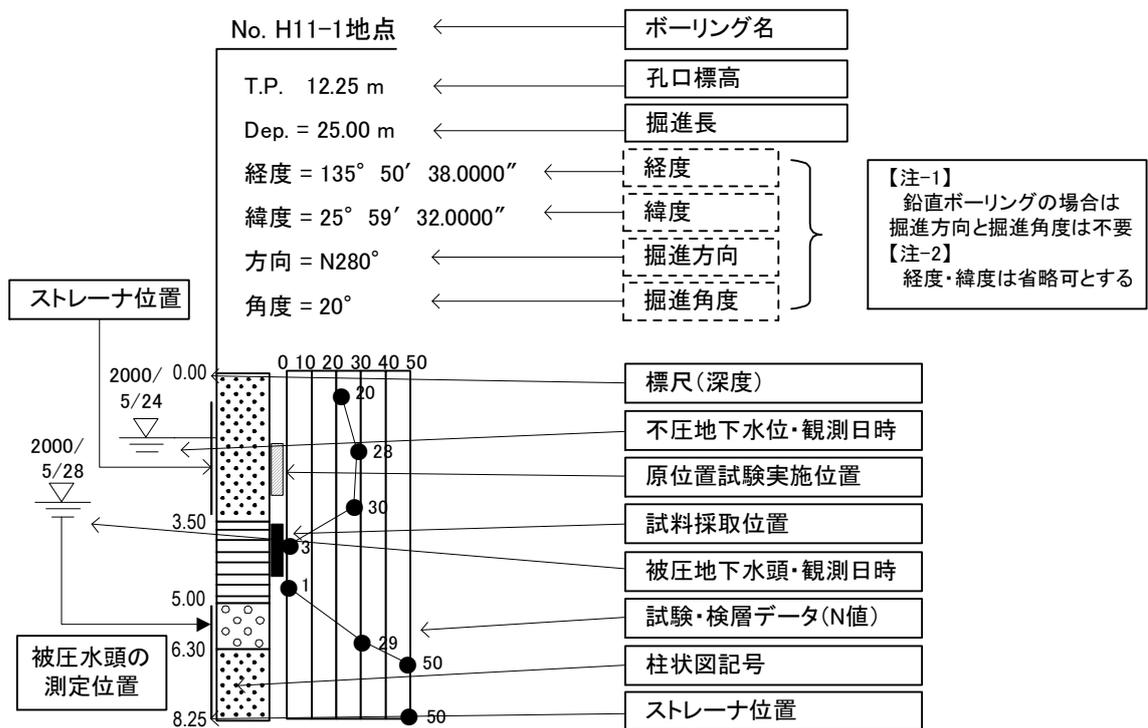
(b) 岩盤ボーリング簡略柱状図
