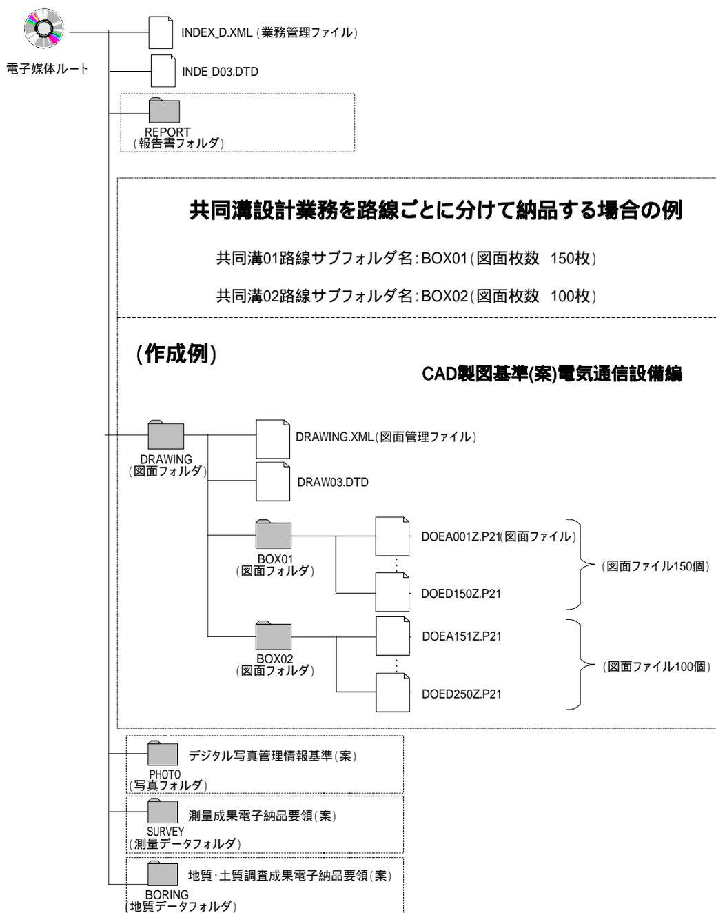
図 1-4 調査設計業務等でサブフォルダ管理する場合のフォルダ構成例
