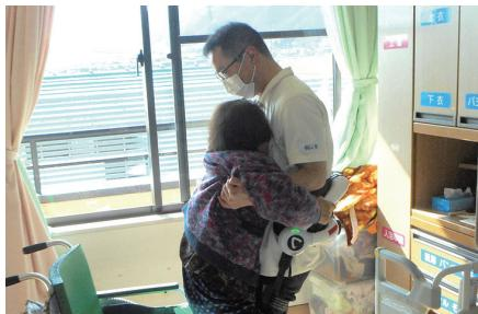
腰装着型の介護支援用ポットHALを3台導入。抱え上げる際に動作がアシストされるため大きな力が要らず、腰への負担が大幅に減少した。
