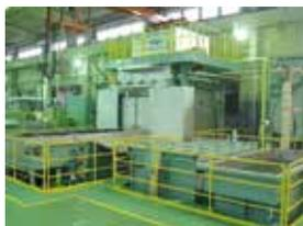
熱処理溶体化炉
