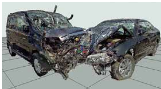
3Dレーザスキャナによる衝突再現
