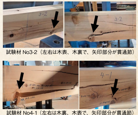
図3 基準強度を下回った試験材
