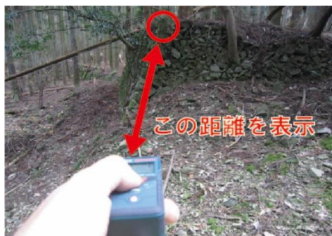
【簡易測量計で距離を計測している様子】
